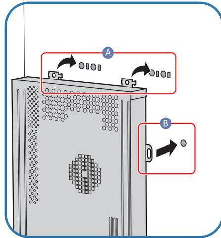
2 Commencez par insérer les pattes du boîtier réseau dans les emplacements (A) sur le cadre de fixation. Les pattes doivent se fixer sur le cadre. Alignez ensuite les trous (B).
